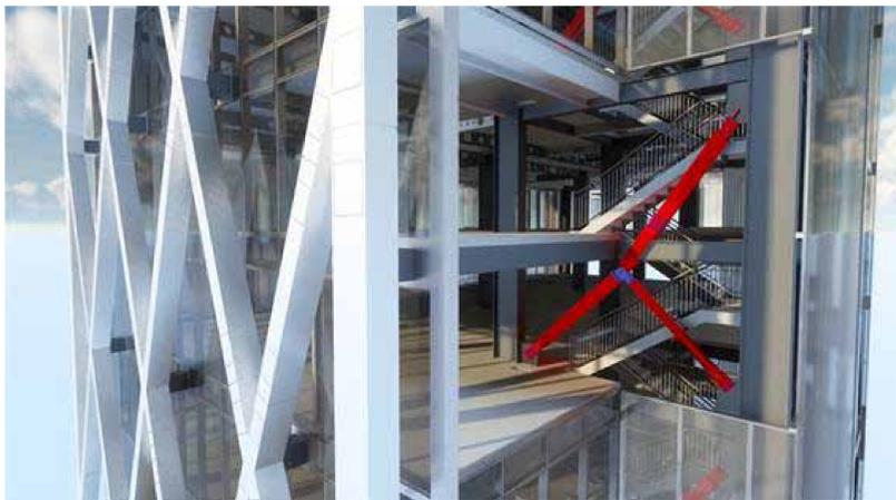
disipadores viscosos. La decisión de implementar este AMS se tomará en la fase final de la construcción del edificio, cuando puedan medirse sus propiedades dinámicas reales, como las frecuencias fundamentales de vibración y amortiguamiento intrínseco. Este proyecto fue seleccionado por el CTBUH1 para formar parte de los casos de estudio en el documento "A Study on the Damping Technologies Available for Tall Buildings: Comfort and Safety", a ser publicado en Octubre de este año.
