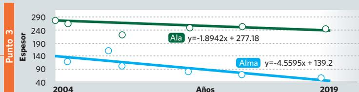
**Punto n°3** de medición: Columna de precipitador (3er piso), Caldera recuperadora Línea II.
